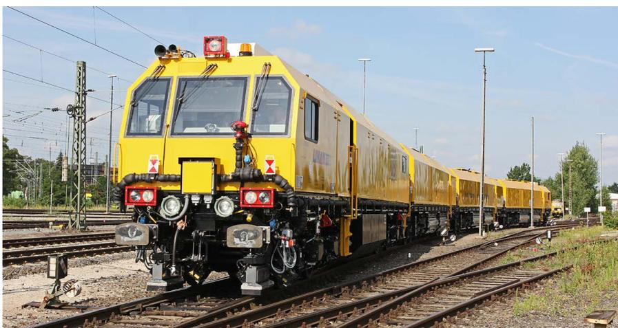
Im PFA 1.1 wird das Besonders überwachte Gleis (BüG) eingesetzt. Dabei überprüft ein spezieller Schleifzug regelmäßig den Zustand der Schienen und schleift diese wenn nötig ab. Damit wird eine Lärminderung von bis zu drei Dezibel erzielt.
