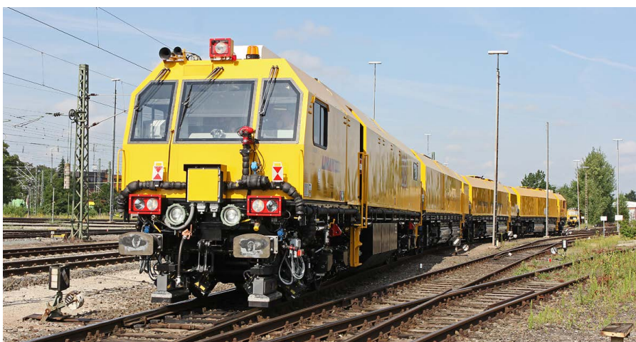
Im PFA 1.1 wird das Besonders überwachte Gleis (BüG) eingesetzt. Dabei überprüft ein spezieller Schleifzug regelmäßig den Zustand der Schienen und schleift diese wenn nötig ab. Damit wird eine Lärminderung von bis zu drei Dezibel erzielt.
