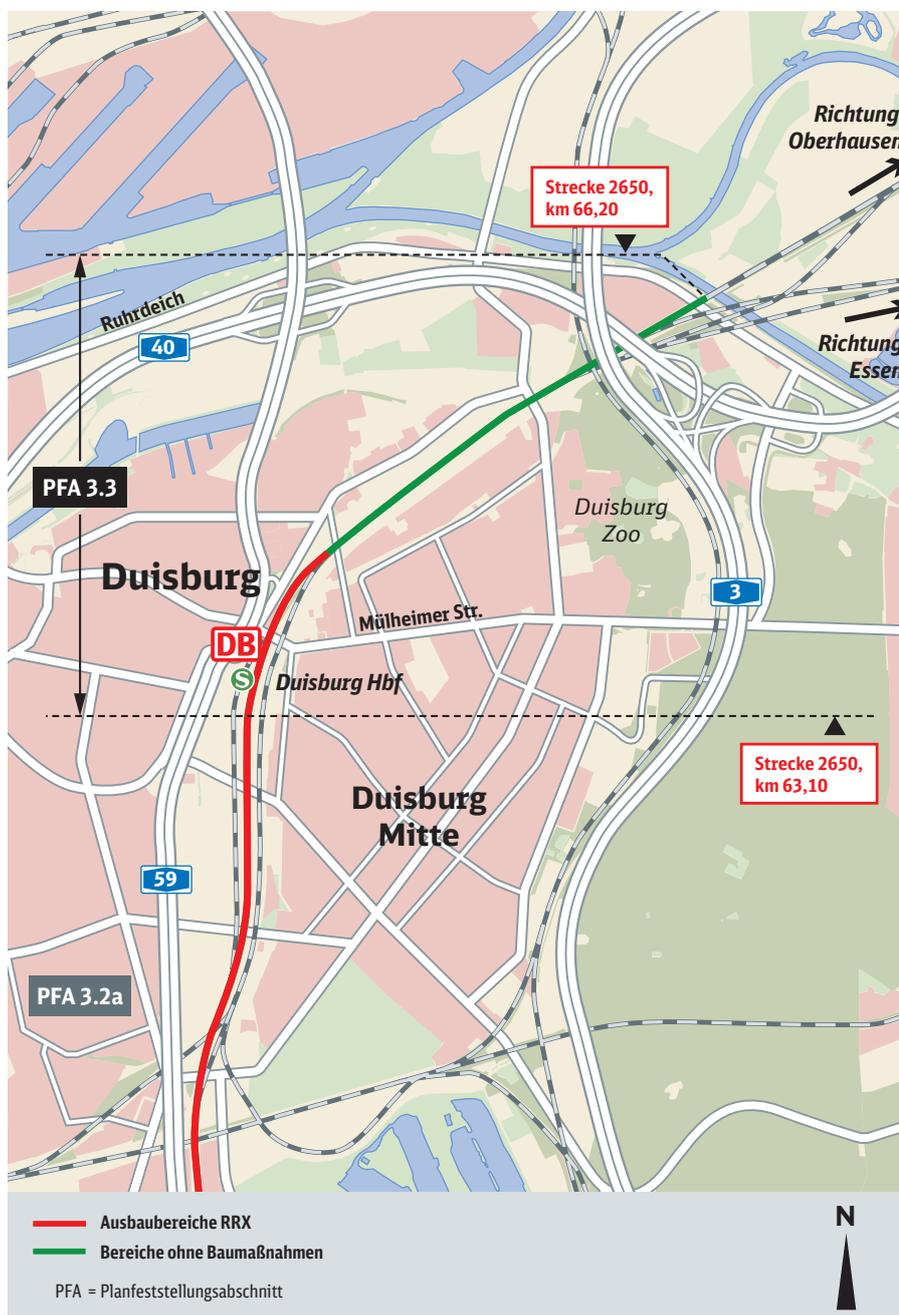
Im Rahmen des Projekts RRX soll die Strecke zwischen Düsseldorf und Duisburg durchgängig auf sechs Gleise ausgebaut werden. Der Abschnitt Düsseldorf–Duisburg ist der am dichtesten befahrene Teilabschnitt im RRX-Kernkorridor. Durch den Bau der erweiterten Infrastruktur für den gesamten Schienenpersonenverkehr kann in diesem Bereich eine deutlich verbesserte und vor allem zuverlässigere Verkehrsleistung angeboten werden.
