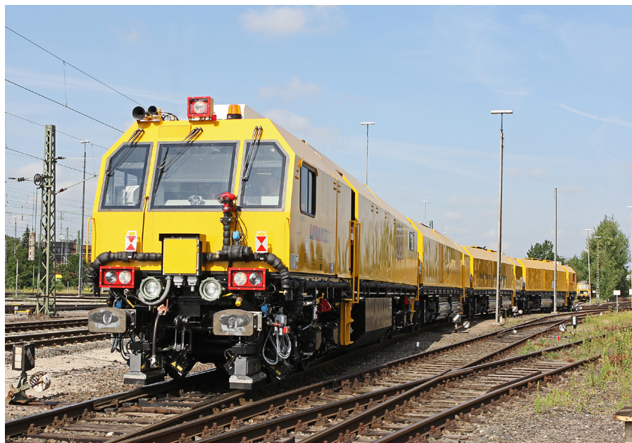
Besonders überwachtes Gleis: Ein Schleifzug glättet die Schienen.
