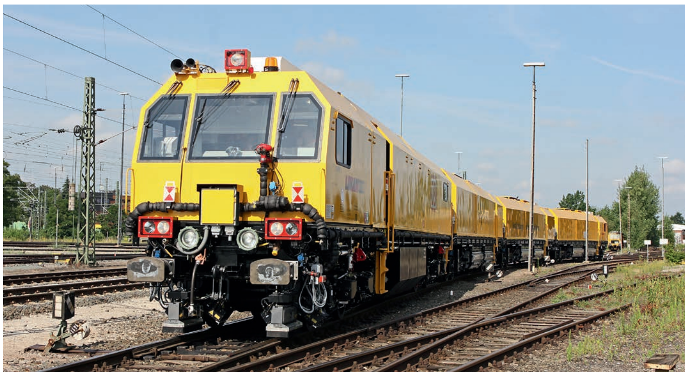
Besonders überwachtes Gleis: Ein Schleifzug glättet die Schienen.
